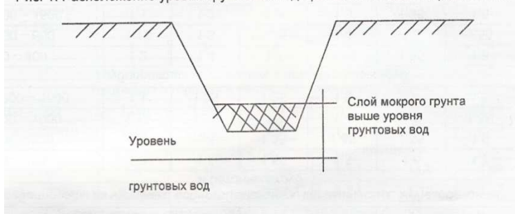
Рис. 1. Расположение уровня грунтовых вод при высоте стояния, равной 0 м.
